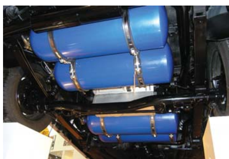
Uložení nádrží s CNG v podvozku vozidla
